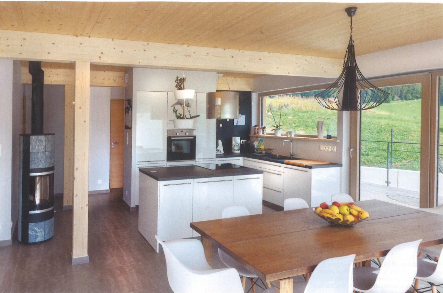
La dalle de l'étage est en lamellé-collé avec une finition lambrissée pour apporter une lumineuse touche boisée au plafond. A noter que sur la dalle, une chape a été coulée pour assurer plus de confort acoustique entre l'étage et la pièce de vie au-dessous.
