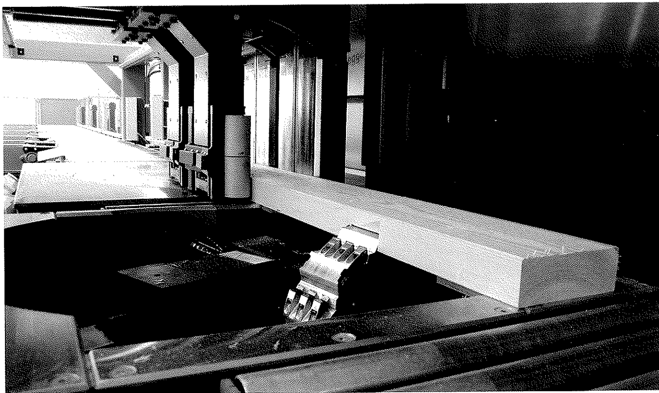
Tout a été préfabriqué en atelier, y compris la taille des charpentes sur la K2 Hundegger de Bois et structures.
