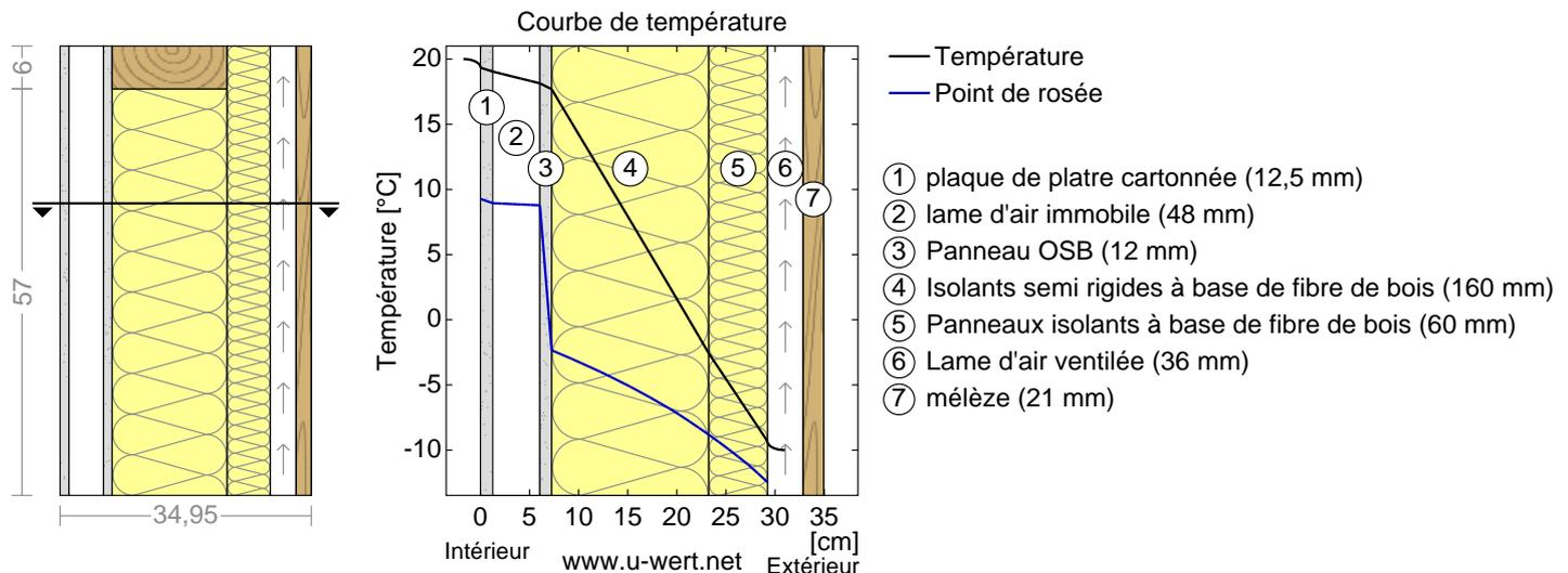
Links: Maßstäbliche Zeichnung des Bauteils. Rechts: Verlauf von Temperatur und Taupunkt an der in der linken Abbildung markierten Stelle. Der Taupunkt kennzeichnet die Temperatur, bei der Wasserdampf kondensieren und Tauwasser entstehen würde. Solange die Temperatur der Konstruktion an jeder Stelle über der Taupunkttemperatur liegt, entsteht kein Tauwasser. Falls sich die beiden Kurven berühren, fällt an den Berührungspunkten Tauwasser aus.
